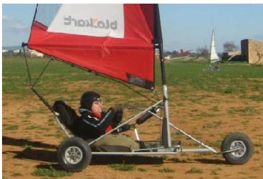
Pau Gispert (ESP, osteogénesis imperfecta) ingeniero y piloto de blokart, muestra como ejemplo, un estudio antropométrico sobre si mismo, para la construcción de un asiento envolvente que le proteja de cualquier impacto y le permita una conducción cómoda y segura.
