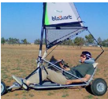
Rafael Winkelman (ESP, lesión C-4 y hemiplejia lado izq.) Durante su primera toma de contacto en blokart y desarrollo de las adaptaciones antropométricas necesarias para poder competir. En este caso, es necesaria la adaptación de una polea eléctrica, que le permita el manejo de la escota, sin tener que soltar el manillar para ello.
